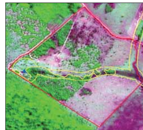
Figura 2 – Imagem Supermode com o mapeamento do limite da propriedade rural (vermelho) e da APP (amarelo)
