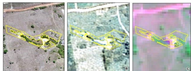
Figura 3. Comparativo entre as imagens obtidas com RPAS (A), satélite SPOT-5 (B) e satélite Sentinel 2-A (C).
